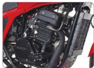
Рядный 2-х цилиндровый двигатель
