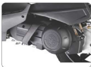
Инжекторный двигатель 250 см 3
