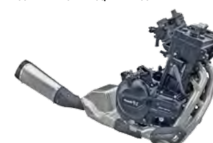
Рядный 2-цилиндровый двигатель DOHC, 8V
