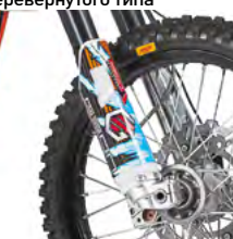
Передние амортизаторы перевернутого типа
