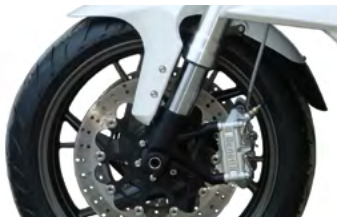
Два плавающих диска 320 мм
