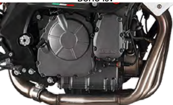
Рядный 4-цилиндровый двигатель DOHC 16V
